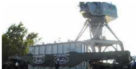
Сербия: трансформатор 400kV 400MVA
