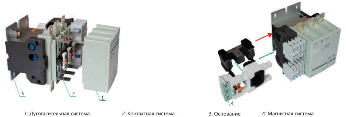
Конструкция контактора NC2-115~265
