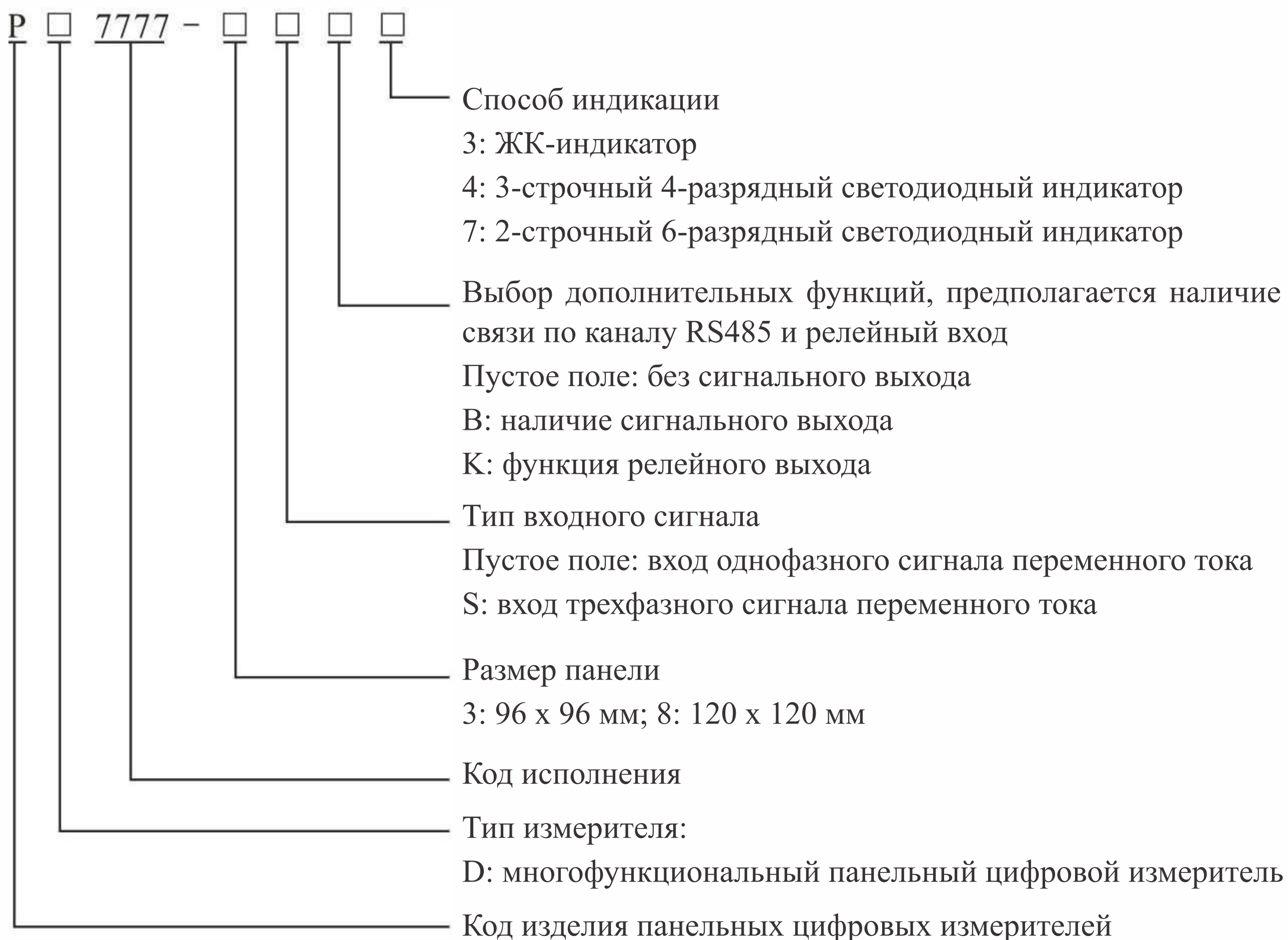
Рисунок 1. PD7777 модель и параметры
